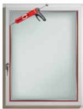
3. Režo med steklom in okvirjem zapolnimo z lepilom.
